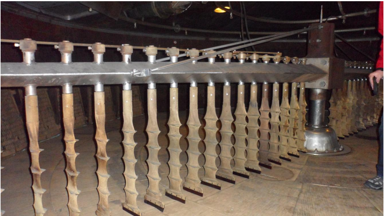
Den indvendige del af den store mashtun med en kapacitet på 8 tons
